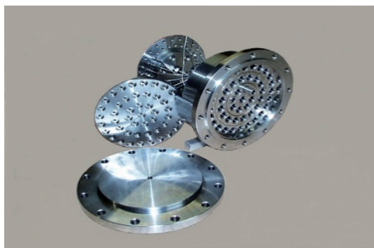
Abbildung 9. Der von der Schüth-Gruppe entwickelte Hochdurchsatzreaktor mit parallelen Kanälen, z. B. für die Methanolsynthese. [59]
